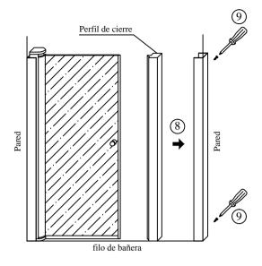
8-9. Introducir el perfil de cierre en el expansor y cuando este bien ajustado con la puerta abatible atornillarlo al expansor por el interior de la bañera.
