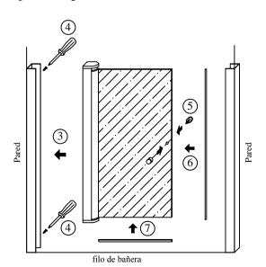
3-4. Introducir la puerta en el expansor y atornillarla al expansor por el interior de la bañera, tal y como se ve en el dibujo.
