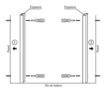
1-2. Atornillar los expansores a la pared con los tornillos y los tacos, habiendo correctamente señalados y hechos los agujeros previamente.
