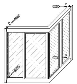
Una vez colocada y fijada a la pared ajustar y fijar con los tornillos (P), cuando este correctamente colocada sellar con silicona a todo alrededor.
