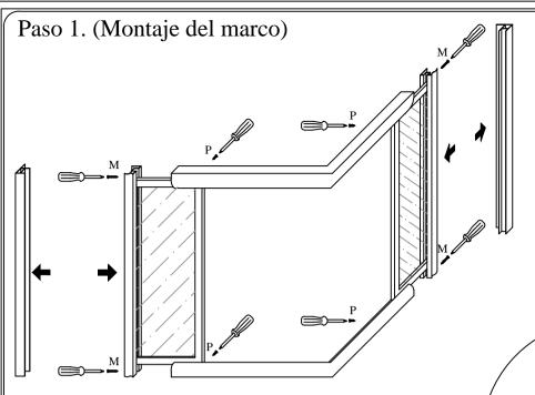
Primero sacar los expansores del marco, despues montar los marcos laterales con los perfiles superior e inferior primero con los tornillos medianos(M) y después con los pequeños(P) y volver a intruducir los expansores.
