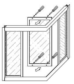
Coger una de las puertas correderas con la goma-iman hacia el centro y atornillarla a las ruedas existentes de uno de los lados del perfil superior e inferior con los tornillos. Regular la posicion de las puertas para su mejor ajuste. Despues hacer lo mismo con la segunda puerta en el otro lado la misma.
