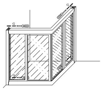
Colocar la mampara pegada a la pared por sus dos extremos y nivelar, despues atornillarla con los tornillos grandes (G) y los tacos, tal y como se ve en la imagen.
