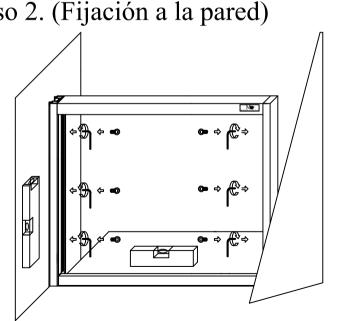
Colocar el marco entre las paredes, ajustar a la pared con una llave allen de 6mm y nivelar
