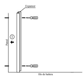
1-2. Atornillar los expansores a la pared con los tornillos y los tacos, habiendo correctamente señalados y hechos los agujeros previamente.
