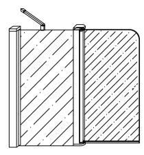
6- Colocar la barra estabilizadora del cristal fijo a la pared, haciendo 45° con el
