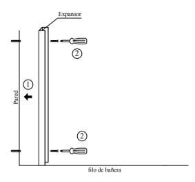
1-2. Atornillar el expansor a la pared con los tornillos y los tacos, habiendo correctamente señalados y hechos los agujeros previamente.
