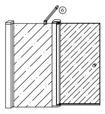
6- Colocar la barra estabilizadora del cristal fijo a la pared de atras, haciendo 90° con el cristal
